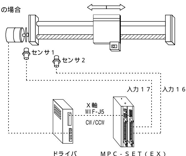
ボールねじスライダーによる 1 軸制御
