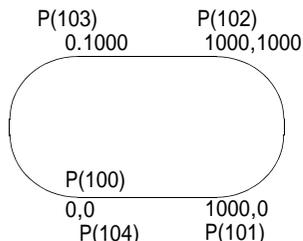
例えば、110の文では点102を指定しています。X\_Aの移動量としてはX(102)-X(101),U\_Aの移動量としてはY(102)-Y(101)が使用されます。CCWの円弧指定のためP(102)へ至る経路は円弧補間となり、その円弧中心はU(102)-X(101),Z(102)-Y(101)となります。ここではXU軸の円弧補間を含む軌跡制御ですが、座標のXYUZというラベルと適用される軸は無関係なことに留意して下さい。
