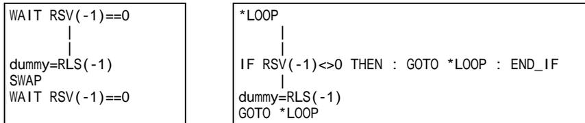
TASK Aはほかのタスクのために1時的にセマフォを解放するが、他にセマフォを獲得するタスクが無ければ再びTASK Aがセマフォを獲得したい。そのためTASK Aがセマフォを解放した状態で必ずタスクを切り替えて他のタスクを実行するようにしたい、という場合はSWAPコマンドをいれます。SWAPのかわりにTIMEを使っても有効ですが、時間的に遅くなります。
