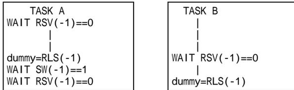
TASK Aがセマフォを解放して、必ず次にTASK Bがセマフォを獲得する、というときはTASK AはSW()でメモリー I/Oを読みTASK Bの獲得を確認する。
